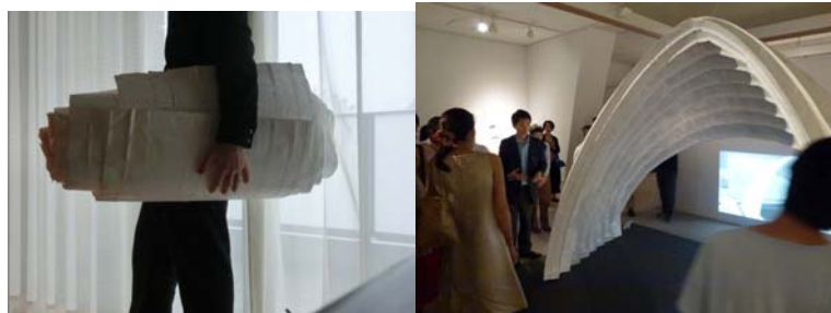
図 3 展開すると硬くなる構造(左)折りたたみ時、(右)展開時
