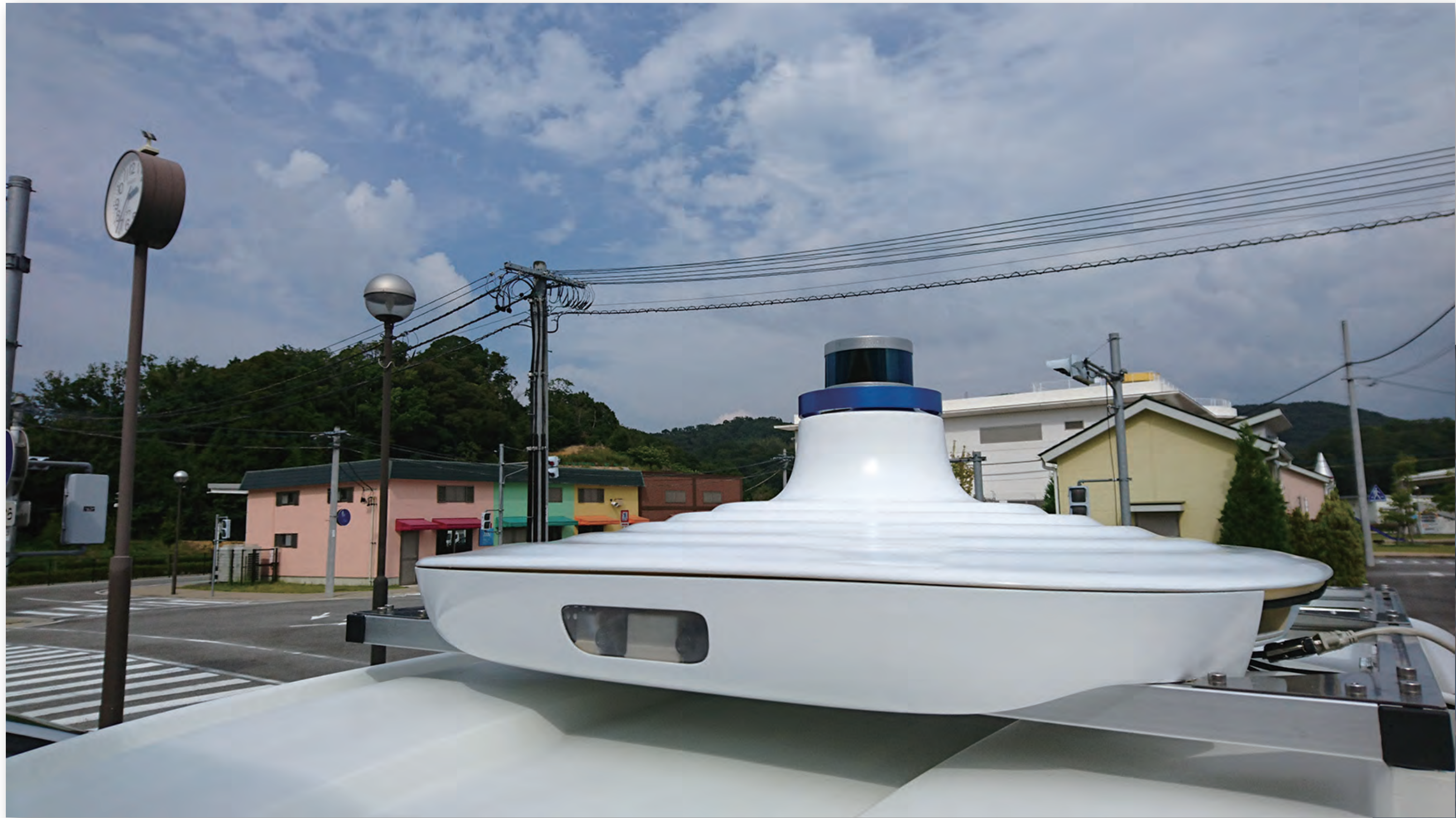
東京大学とティアフォーで共同開発した自動運転システム開発キット「AIパイロット」
