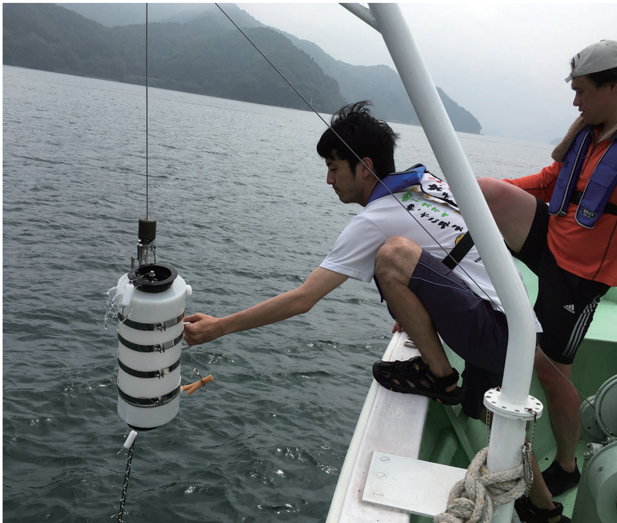
海での採水の様子。バンドーン採水器という機器を用いて、深層の水を得ている場面である。
