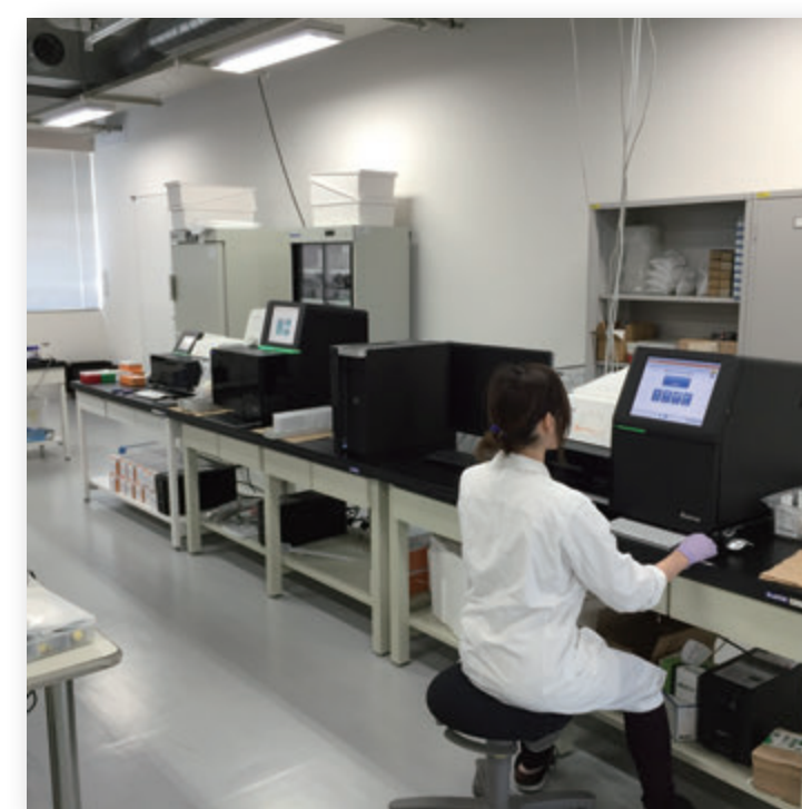
遺伝子解析装置：デスクトップ型超並列シーケンサー 便中に含まれる腸内細菌の遺伝子情報を網羅的に解析する装置 得られた情報はバイオインフォマティクスによりコンピューターで解析
