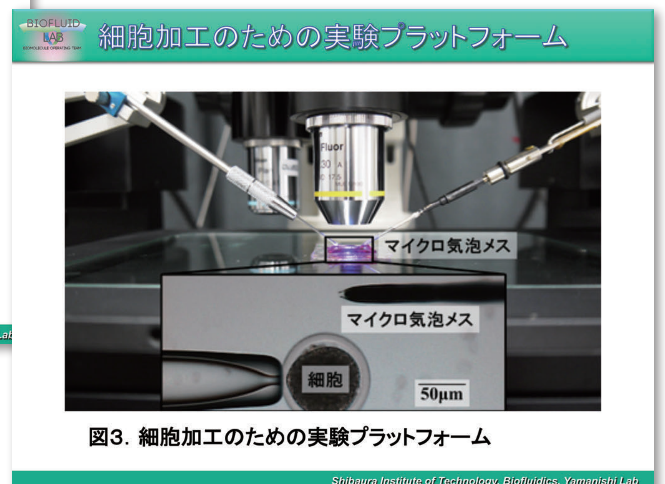
図2. 電界誘起気泡による細胞(ウシ卵子)加工の様子
