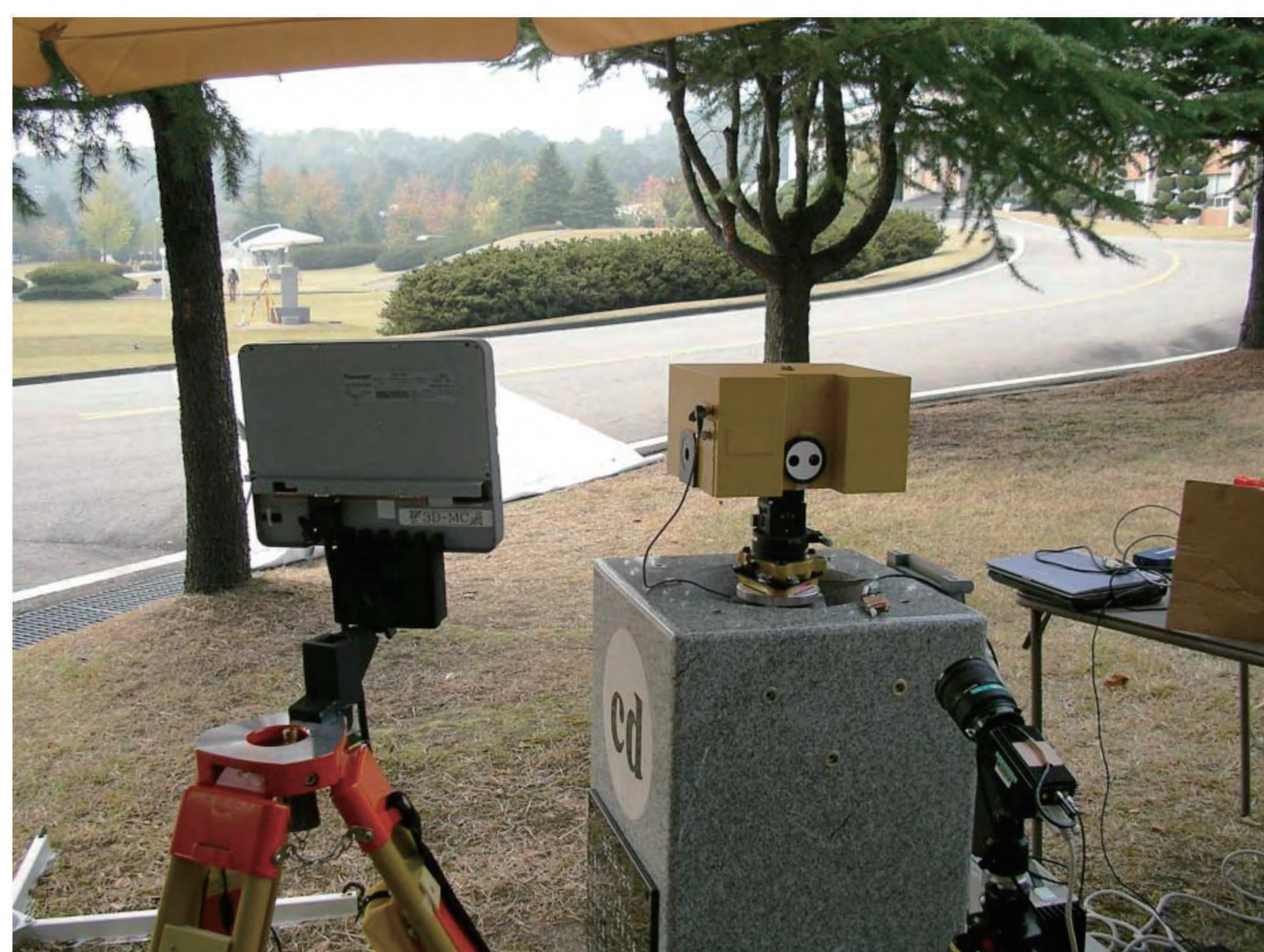
光コムを用いた超高精度の絶対距離計。 マイクロメートルレベルの精度で数百メートルの距離が測定できます。
