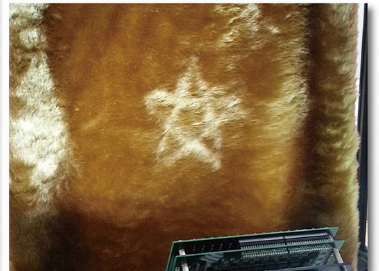
毛布の毛並みを変えることで自動的に絵を描いたり消したりすることができます。(慶應義塾大学との共同研究)
