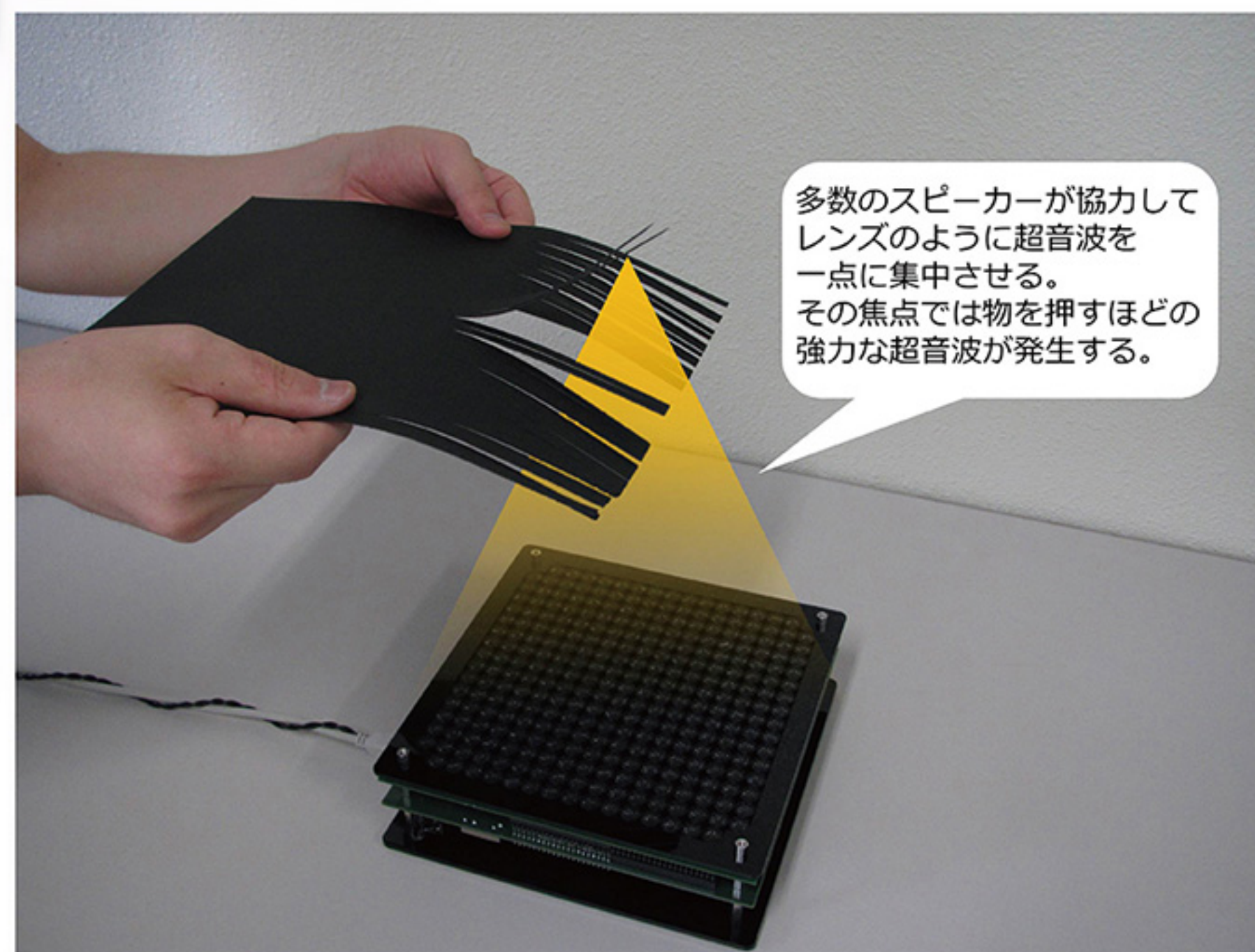
細い紙を持ち上げているのは、強力な超音波(耳に聞こえないほど高い音)による力です。 この触れずに働く力を巧みに使って、様々な新しいこと・面白いことを実現しています。
