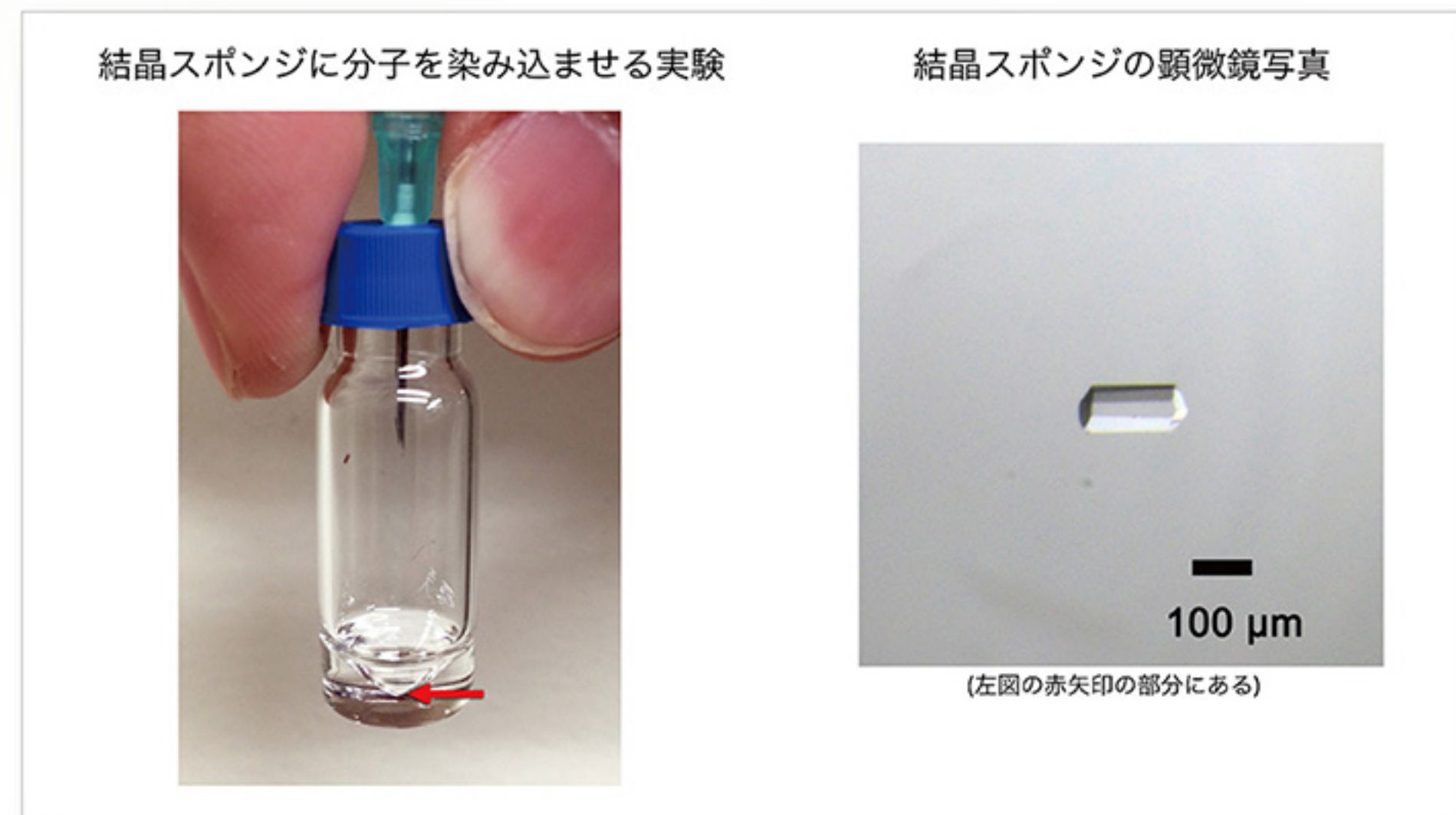
結晶スポンジ法に用いるバイアル (左) と結晶スポンジの顕微鏡写真 (右)
