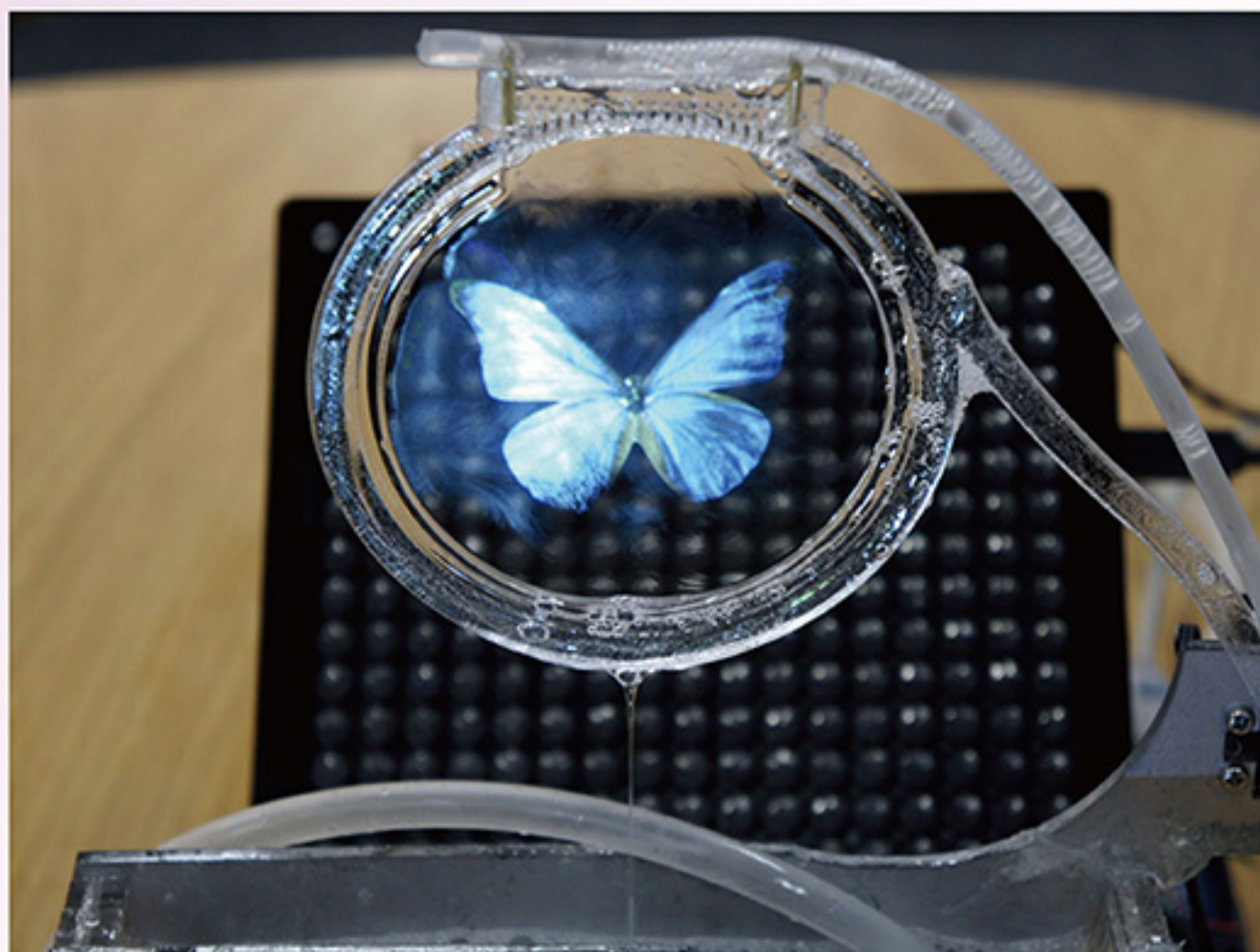
普段は透明なシャボン膜も、超音波で振動させると映像を映し出せるようになります。(東京大学との共同研究)
