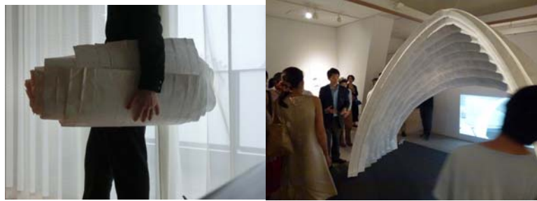
図 3 展開すると硬くなる構造(左)折りたたみ時、(右)展開時
