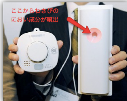
わさび火災報知器
