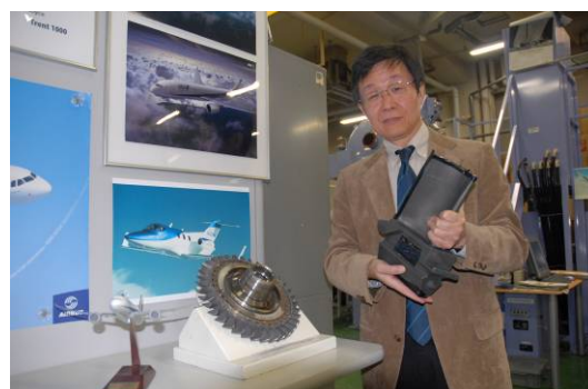
手にしているのは、開発合金を用いて鋳造した複合発電用単結晶タービン動翼
