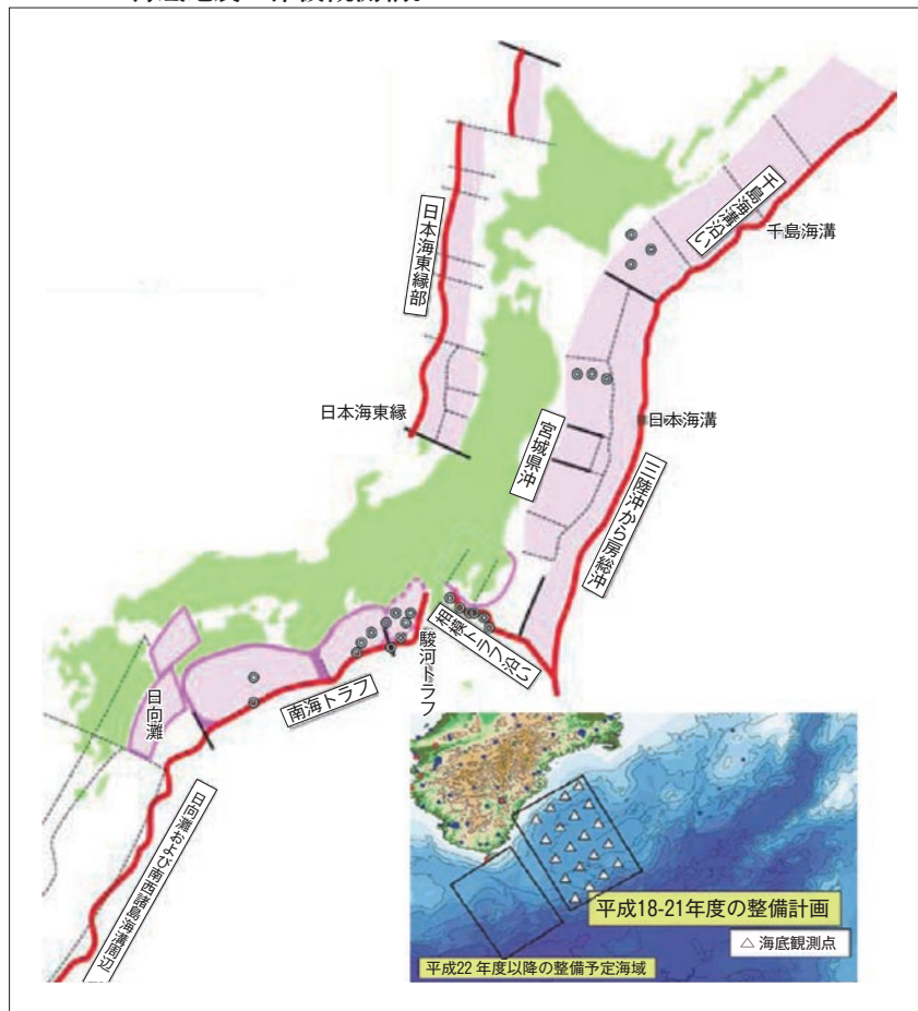
図表8 想定される海溝型地震とケーブル式海底地震計(◎)。右下図は、南海トラフ地震に向け、(独)海洋研究開発機構が熊野灘に整備中の海底地震・津波観測網。
